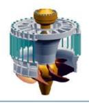
一种最小叶片间距转轮Kaplan水轮机 的图示
