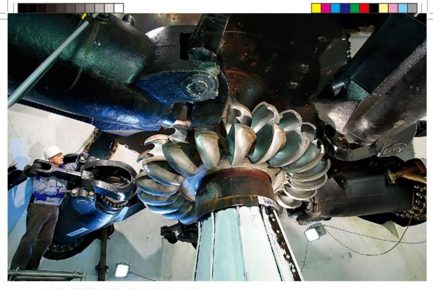
带改良型Tosi喷射器的冲击式转轮,在修改后完全组装完毕,等待调试。
