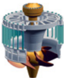
Visão esquemática de uma turbina Kaplan com folga mínima
