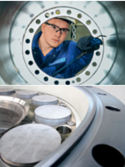
As preocupações ecológicas foram um fator decisivo no desenvolvimento da StreamDiver. Uma importante característica são os seus mancais totalmente lubrificados por água para prevenir a contaminação por óleo e graxa.
