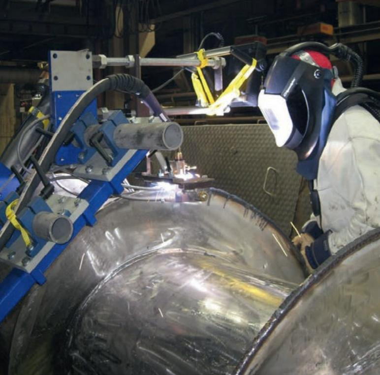
Voith SmartGrinder für optimale Vor-Ort-Services zur Aufarbeitung von Schneckenpressen
