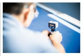
**Präzise Prüfung**Ein Voith Mitarbeiter misst die Härte eines Schuhpressmantels.
