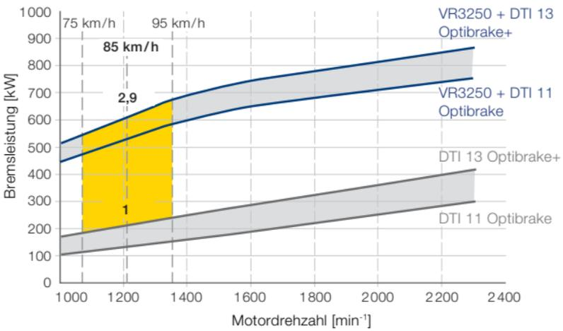
■ Durch die Kombination aus Retarder und Motorbremse wird die Bremsleistung des Fahrzeugs nahezu verdreifacht
