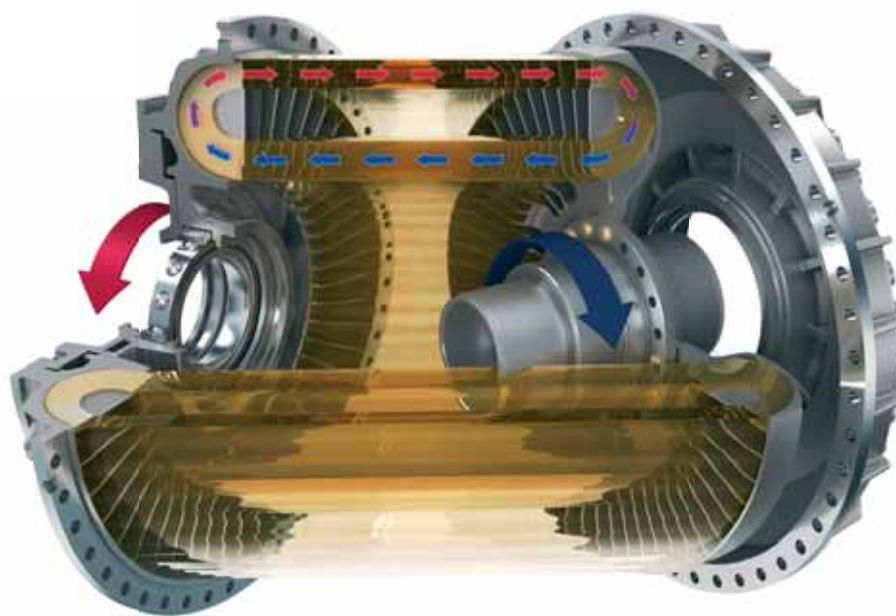
图 14：恒充式液力耦合器起动过程中工作液分布的 3-D 截面模型
