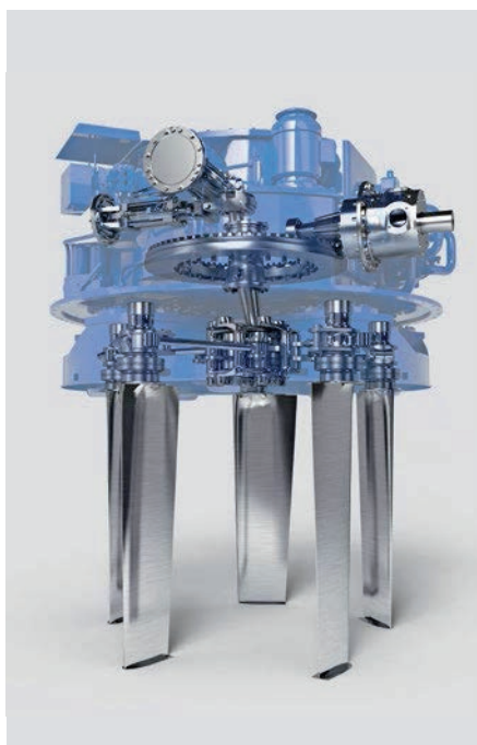
Figure 2: Voith Schneider Propeller (X-ray view)
