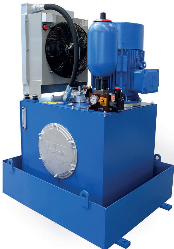
Hydraulikaggregat mit SLE 40
