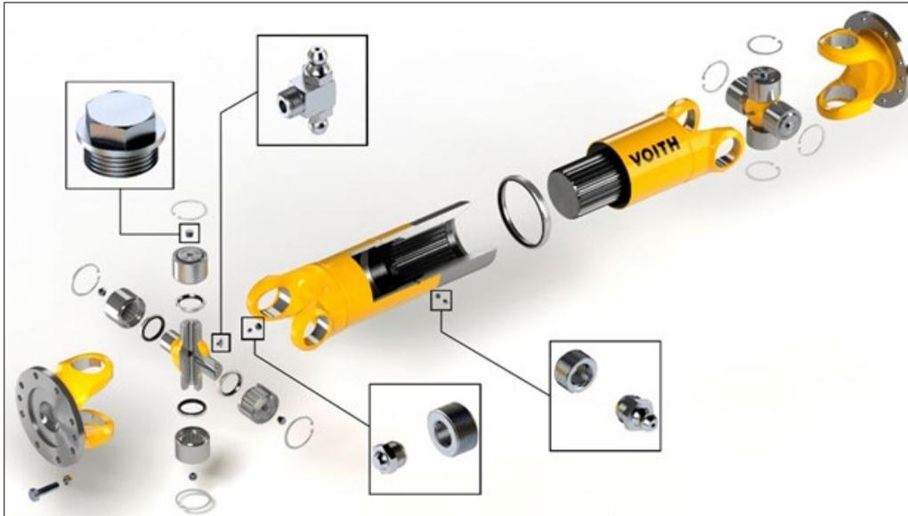
Abb. 3.1: Aufbau der Gelenkwelle (Beispiel Typ RT)
