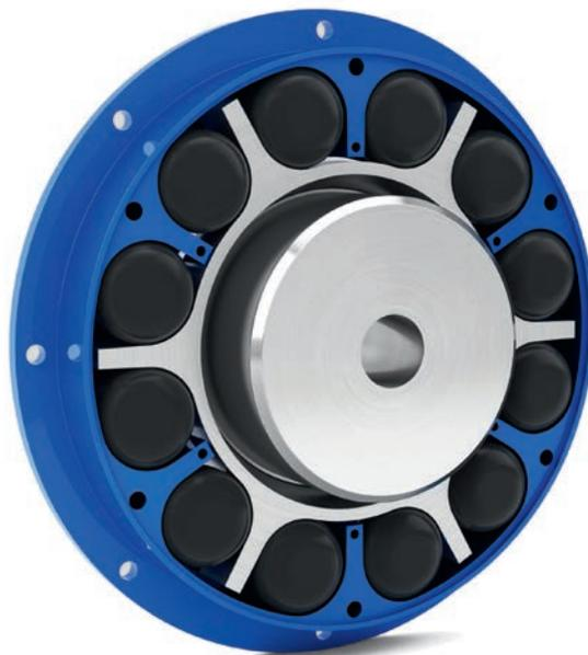
Die Kupplung ist praktisch wartungsfrei und erfordert keine Schmierstoffe. Lediglich die Elastomerelemente unterliegen einem natürlichen Verschleiß. Ein Austausch der Elemente ist sehr einfach, da die Kupplung aus nur drei Hauptbauteilen besteht. Sie senken damit die Stillstandzeiten und vermeiden Folgekosten. Mit geringeren Instandhaltungskosten optimieren Sie die Betriebskosten.
