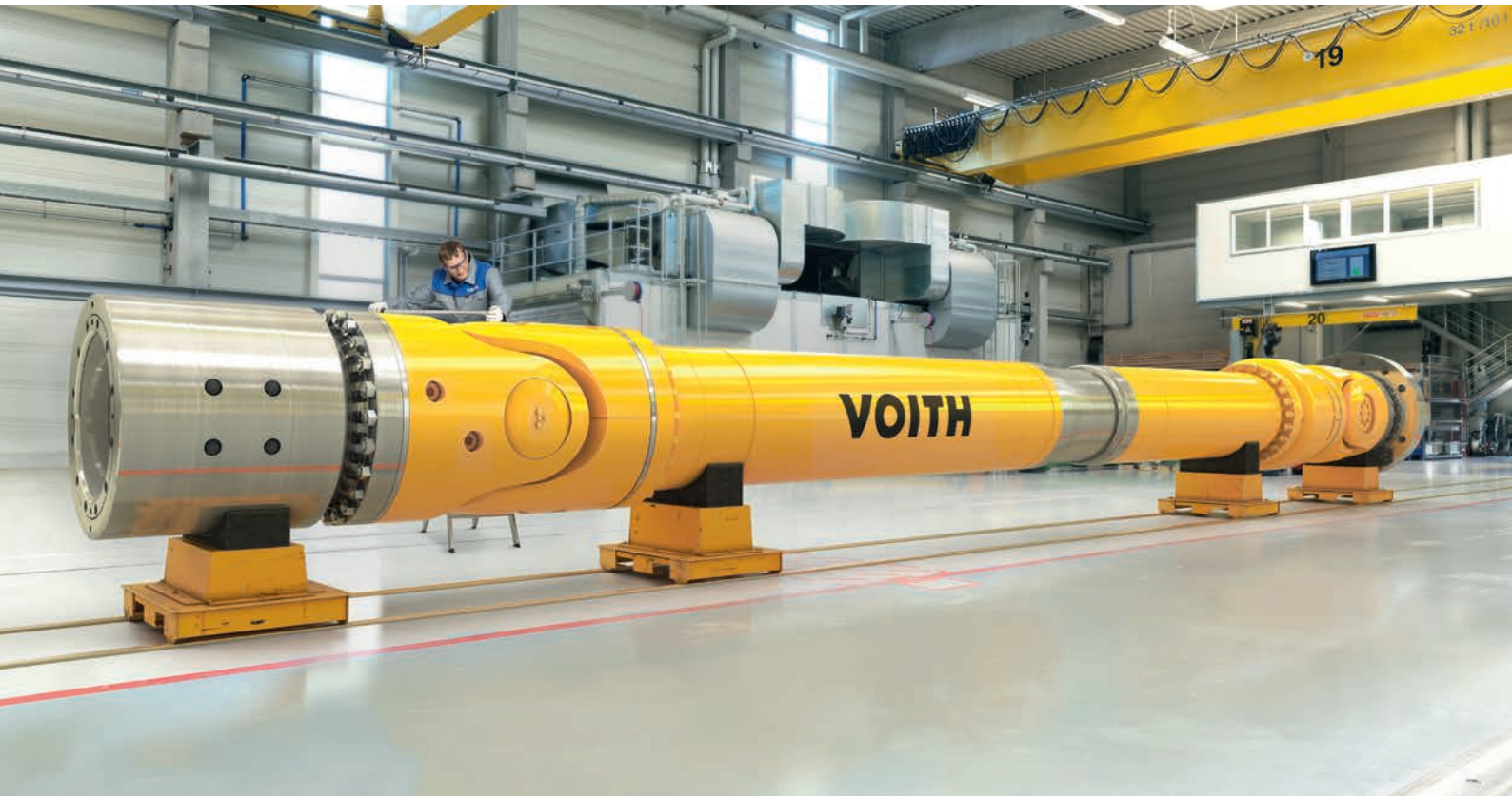
组装间中的高性能万向轴；E 型万向节（左）
