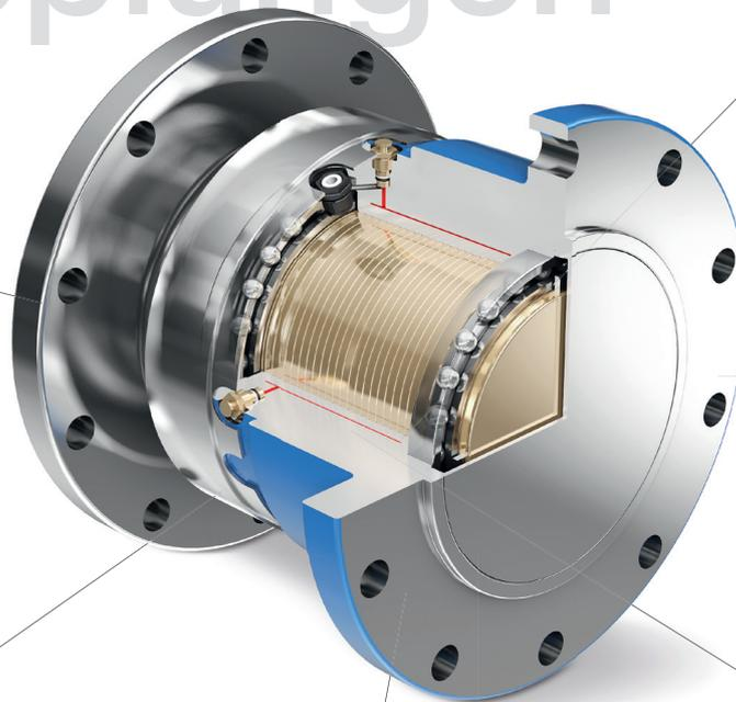
Voith Hirth-Verzahnungen verbinden die Komponenten des elektrischen Antriebsstrangs mit höchster Präzision und maximaler Drehmomentkapazität. Die formschlüssigen Verbindungskomponenten sind spielfrei und selbstzentrierend. So profitieren Sie von geringem Ausrichtungsaufwand und hoher Betriebssicherheit.
