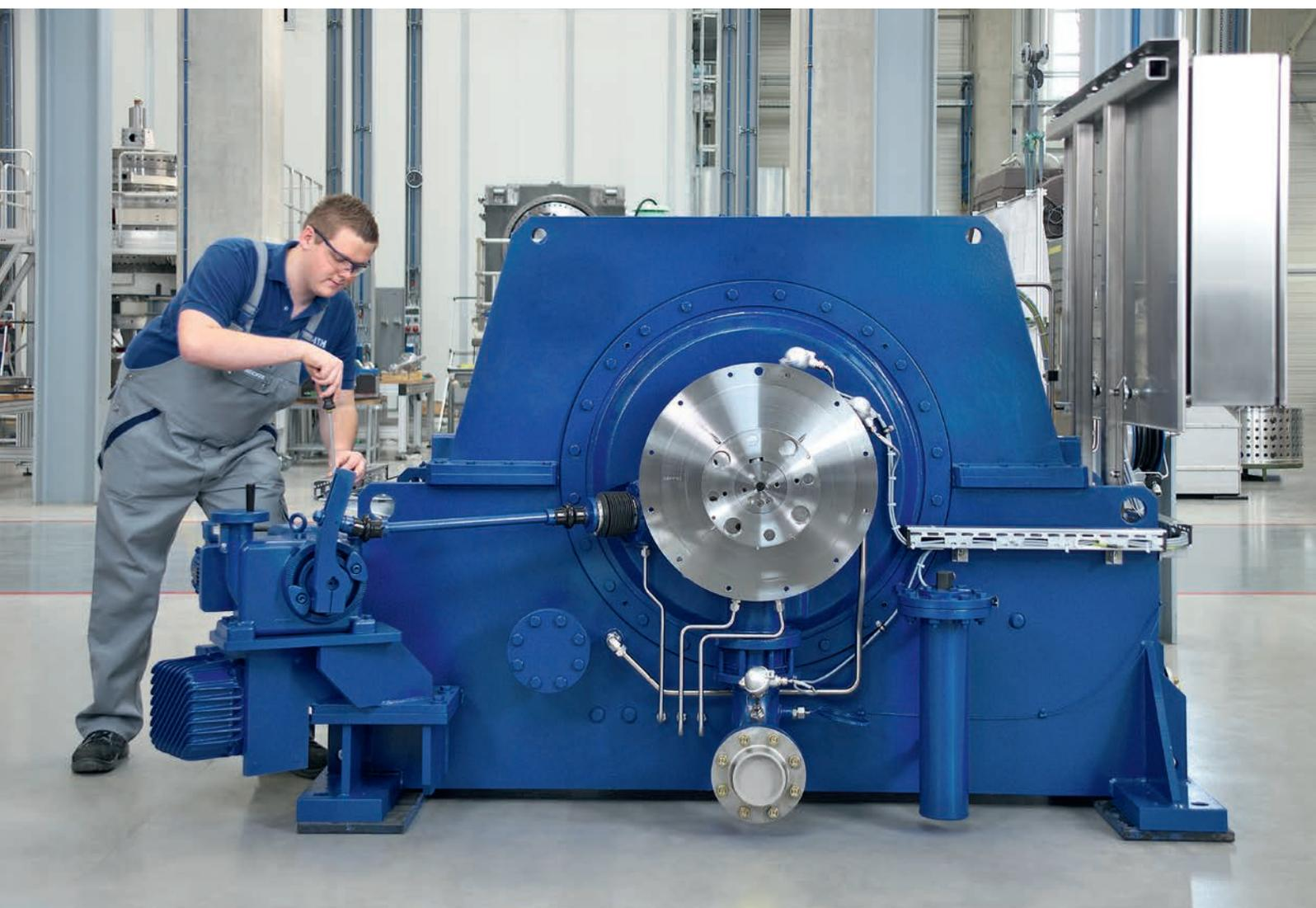
Гидродинамические муфты с регулируемой частотой вращения Voith — это безупречная работа на протяжении более 68 лет при диапазоне передаваемой мощности от 100 до 35 000 кВт.
