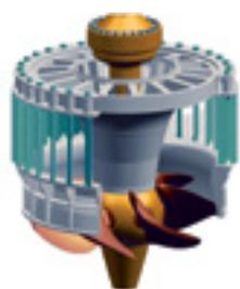
Visión esquemática de una turbina Kaplan con huelgo mínimo
