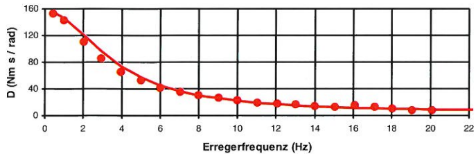
Bild 10: Dämpfung D - Messungen (Punkte), Theorie (durchgezogen)
