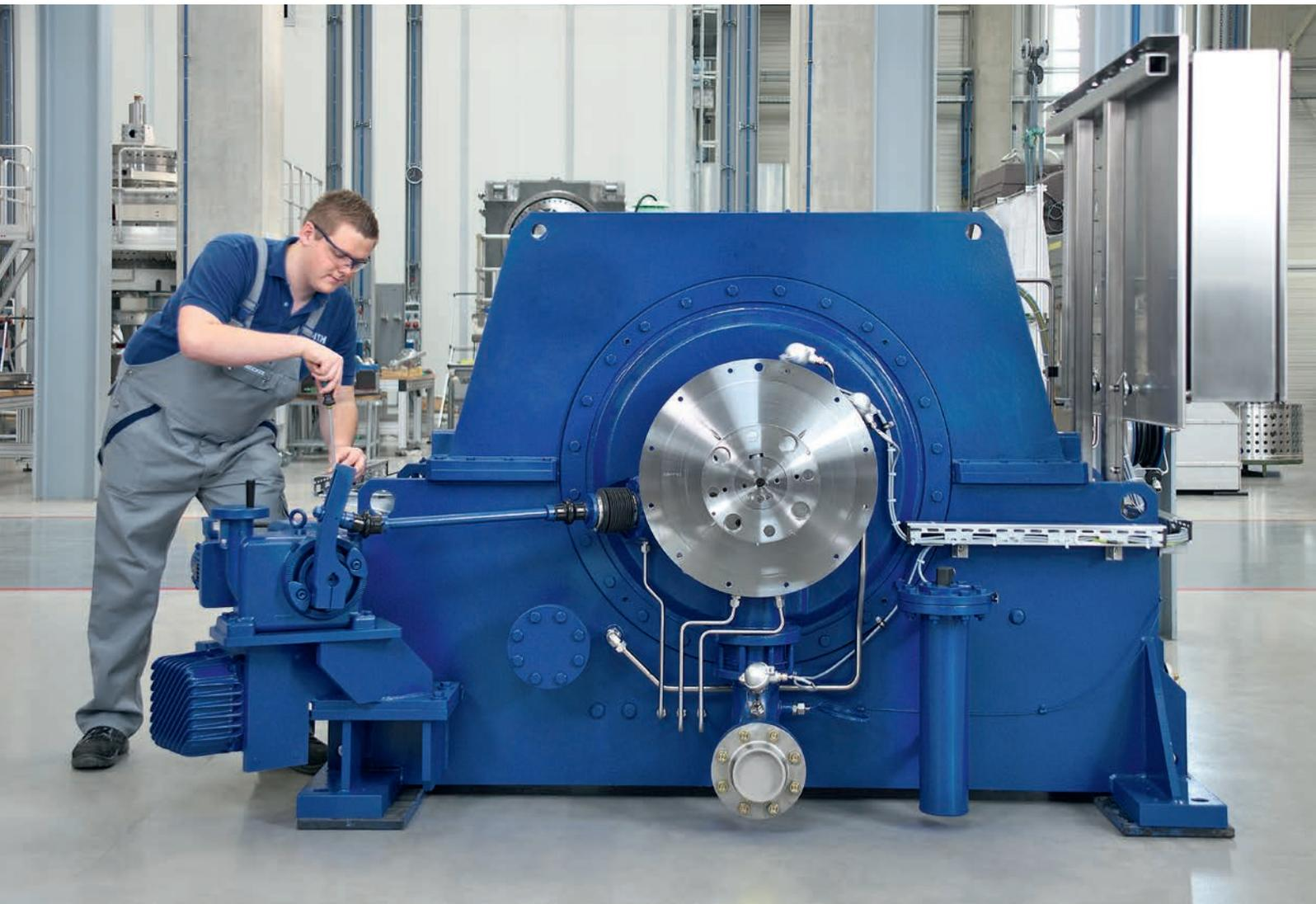
Os acoplamentos hidrodinâmicos de velocidade variável da Voith oferecem um funcionamento sem problemas há mais de 68 anos e permitem transmissões de potência de 100 kW a 35 000 kW.
