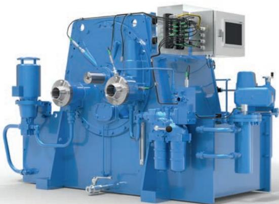
Como novo sistema digital de medição inteligente para acoplamentos de velocidade variável, o OnCare.Health IOLIS transmite digitalmente dados de processo do acoplamento para a sala de controlo através de protocolos BUS (ProfiNet, ModBus ICP, Ethernet IP). O sistema pode ser facilmente instalado em acoplamentos existentes e em novos acoplamentos.
