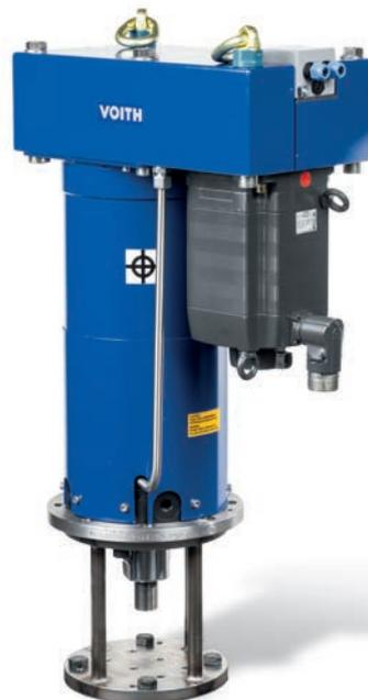
Ein elektromechanischer Antrieb EMA ist ein linearer und ölfreier Stellantrieb. Er ist an das Regelventil angebaut und betätigt es direkt. Die Regelgröße ist der Hub  $s$  der Aktuator-Spindel, deren Positionsrückmeldung im Antrieb integriert ist.
