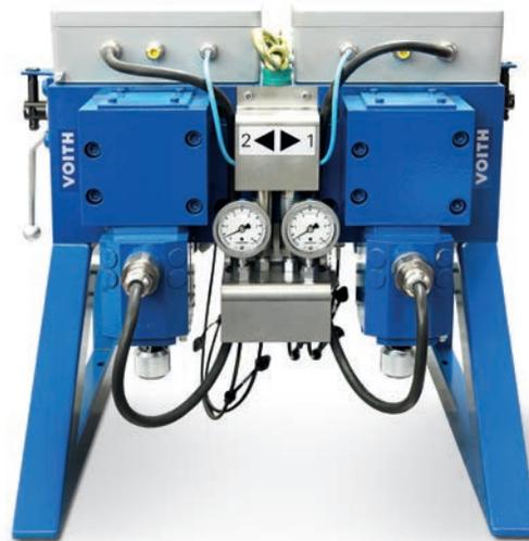
Ein Wegeschiebermodul ist ein vollständig redundantes System mit zwei parallel angeordneten Wegeschiebern (heiße Redundanz). Eine elektronische Fehlererkennung ist integriert. Eine hydraulische Maximalauswahl stellt die Funktion bei Ausfall eines Wegeschiebers sicher.
