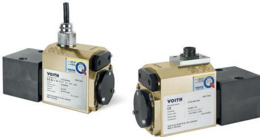
Ein CTo erkennt Überdrehzahl und steuert den Hydraulikzylinder, der das Schnellschlussventil betätigt, direkt an. Die Baugruppe ist kompakt und hat kurze Signalwege. Der Anbau erfolgt üblicherweise direkt an den Hydraulikzylinder des Schnellschlussventils.
