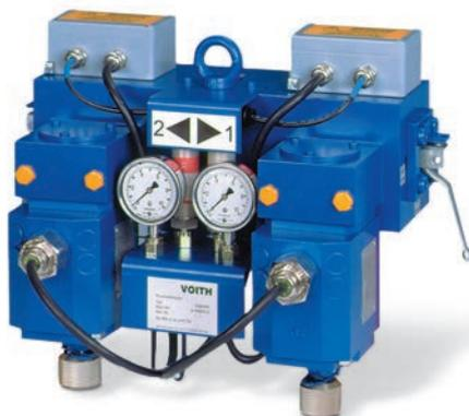
Ein Druckstellmodul ist ein vollständig redundantes System mit zwei parallel angeordneten Druckstellgliedern (heiße Redundanz). Eine elektronische Fehlererkennung ist integriert. Eine hydraulische Maximalauswahl stellt die Funktion bei Ausfall eines Druckstellglieds sicher.
