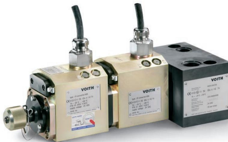
Ein Tandem-Wegeschieber ist ein Wegeschieber mit zwei Regelmagneten. Diese Regelmagnete sind in Reihe angeordnet und bilden eine redundante Einheit (warme Redundanz). Bei Fehlfunktion eines Regelmagnets übernimmt der andere die Regelaufgabe. Die Umschaltlogik ist extern in der Leittechnik angeordnet und überwacht die Regelmagnete.
