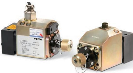
Ein Druckstellglied ist ein Strom-Druck-Wandler. Es steuert das Pilotventil eines Hydraulikzylinders an, der das Regelventil betätigt. Der Hydraulikdruck  $p$  ist die Regelgröße. Die Positionsrückmeldung der Kolbenstange zum Pilotventil erfolgt in der Regel mechanisch. Diese Lösung ist einfach, zuverlässig und kostengünstig.
