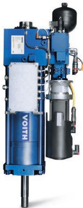
Ein autarker Stellantrieb SelCon ist ein linearer, elektrohydraulischer Antrieb ohne externe Ölversorgung. Er ist an das Regelventil angebaut und betätigt es direkt. Die Regelgröße ist der Hub  $s$  der Kolbenstange, deren Positionsrückmeldung im Antrieb integriert ist. Ebenso ist das in sich geschlossene Hydrauliksystem im Antrieb integriert.
