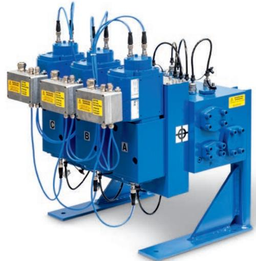
Ein Trip-Auslöseblock ist eine elektrohydraulische Sicherheitssteuerung. Er steuert den Hydraulikzylinder, der das Schnellschlussventil betätigt, direkt an. Der Aufbau ist dreifach redundant mit einer 2-von-3-Auswahl (2oo3). Eine hohe Durchflussrate ermöglicht sehr kurze Schnellschlusszeiten. Alle Magnetventile sind im Betrieb tauschbar.
