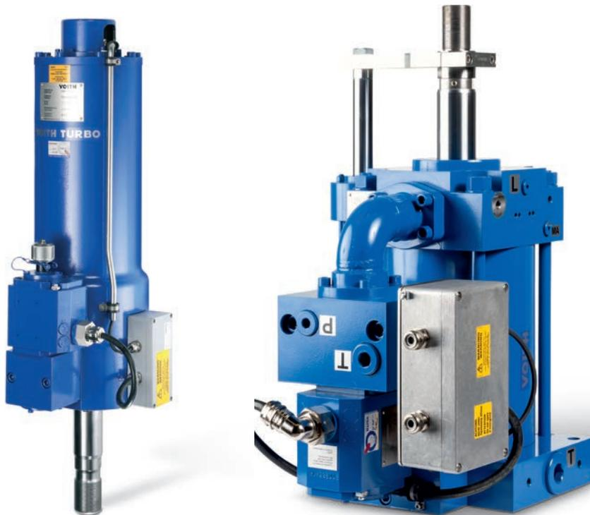
Ein Regel-Servomotor ist ein linearer, elektrohydraulischer Stellantrieb. Er ist an das Regelventil angebaut und betätigt es direkt. Die Regelgröße ist der Hub  $s$  der Kolbenstange, deren Positionsrückmeldung im Servomotor integriert ist. Regel-Servomotoren sind mit einfach- oder doppelwirkenden Zylindern erhältlich. Verschiedene Komponenten der Servomotoren sind redundant ausführbar.
