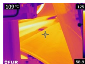
Stahlzylinder mit gleichmäßiger Oberflächentemperatur
