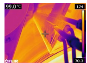
Gusseiserner Zylinder mit ungleichmäßiger Temperatur am Mantelrand
